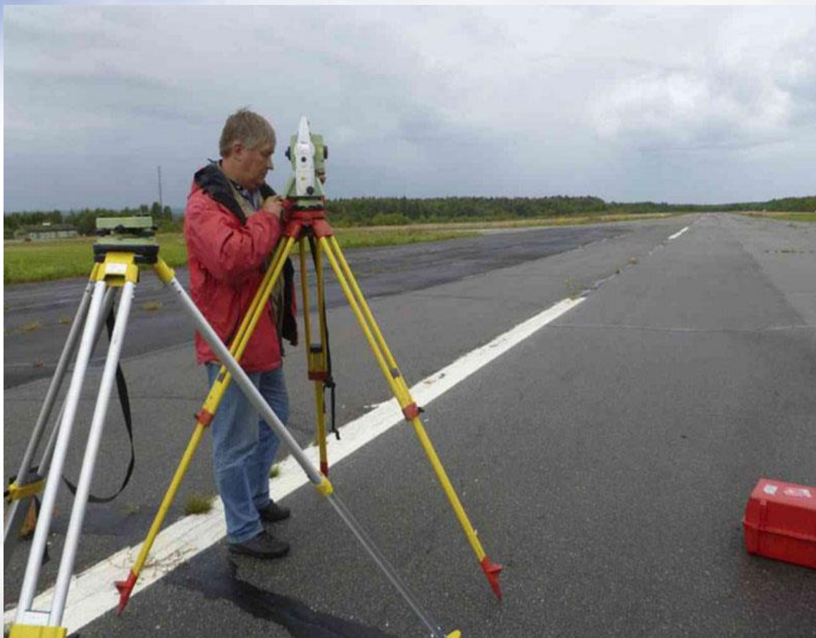
Процесс съемки препятствий
