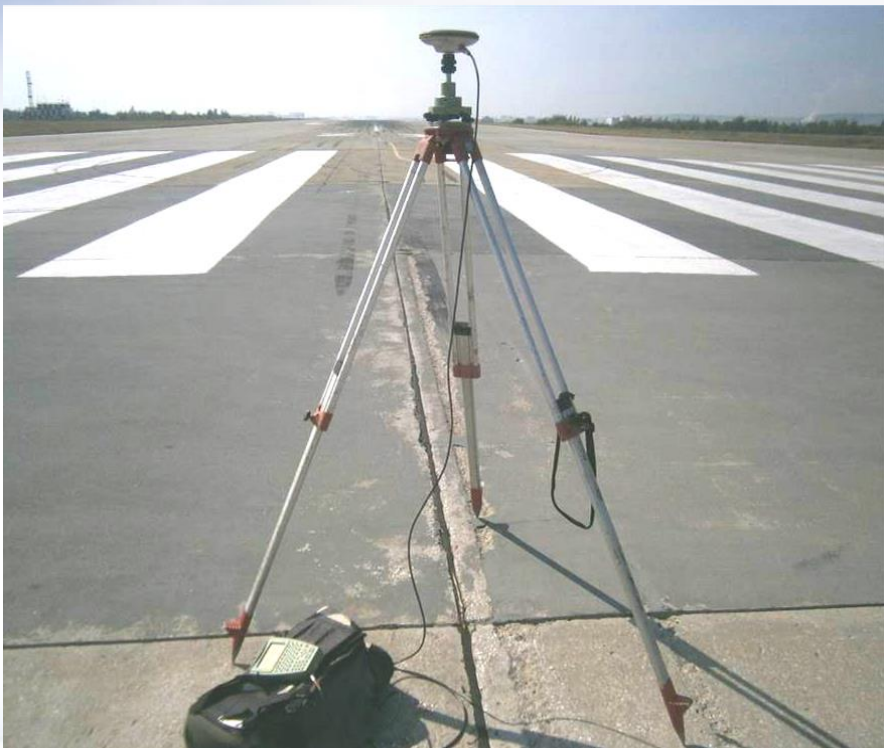
Определение координат порога
