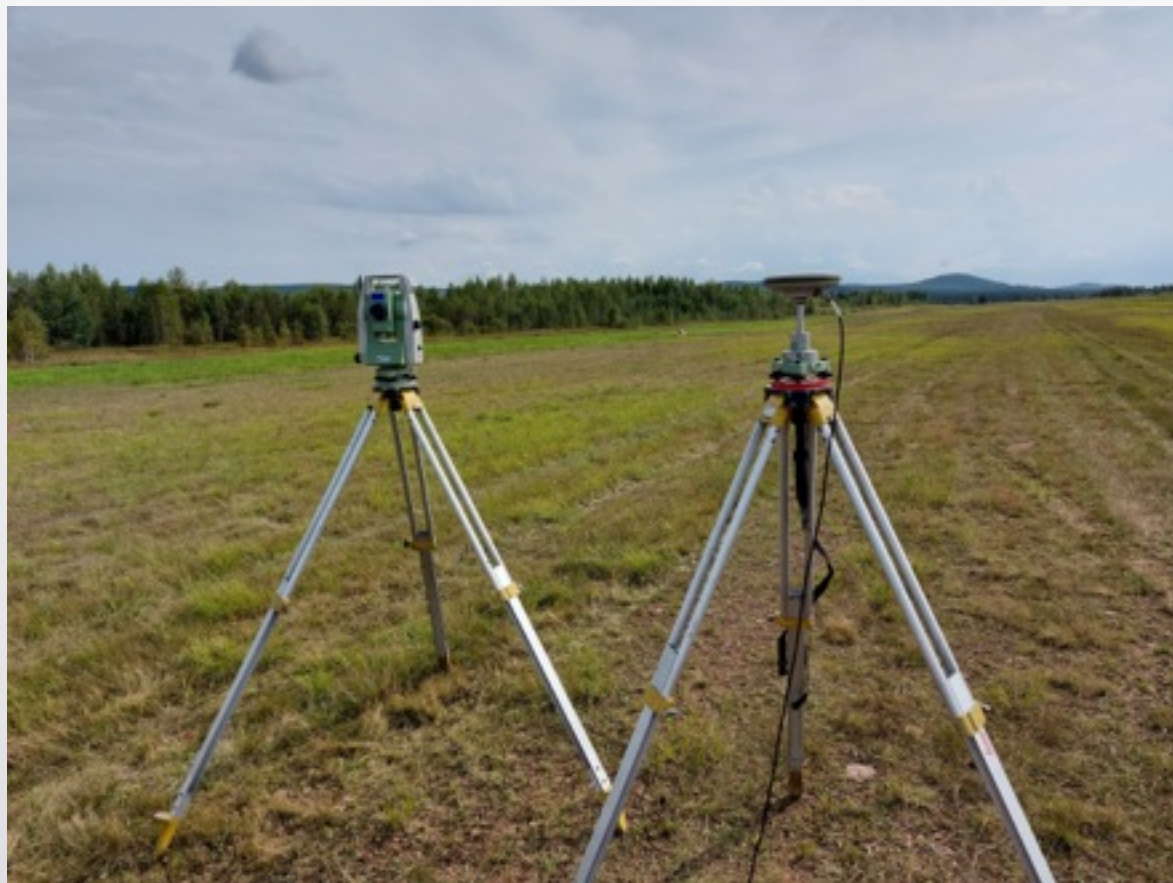
Рисунок 9 – Методика измерений координат препятствий
