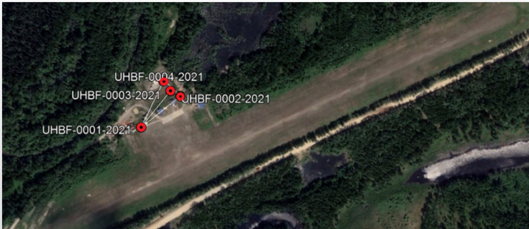
Рисунок 3 - Схема опорной геодезической сети
